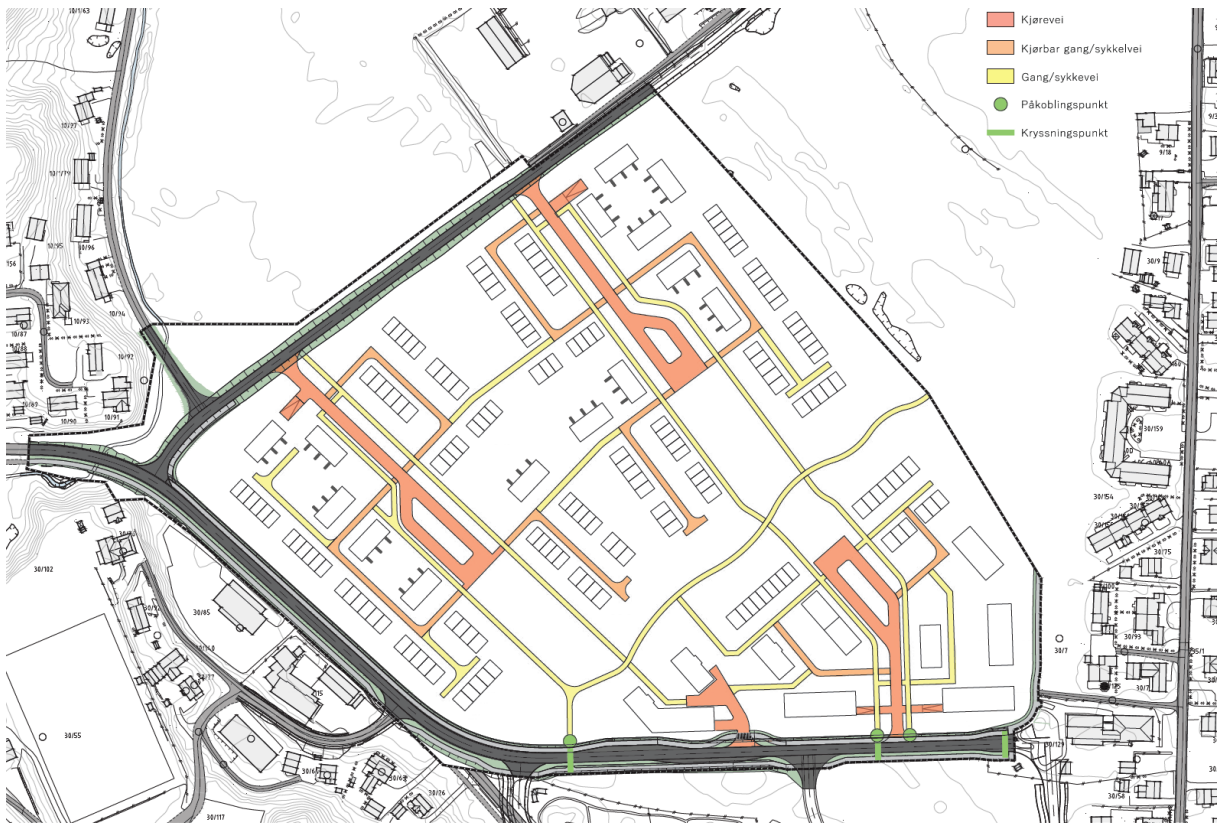
Bilde 13: Trafikk; gule linjer viser gang- og sykkelveier, oransje linjer viser kjørbare gang- og sykkelveier, rødt viser kjøreveier. Kilde: YME.
